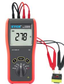
变压器线阻测量
