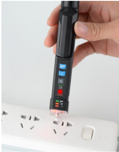
零线/火线测试
