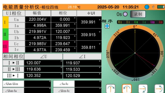
相位测量-三相四线测试界面
