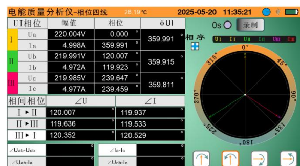
相位测量-三相四线测试界面
